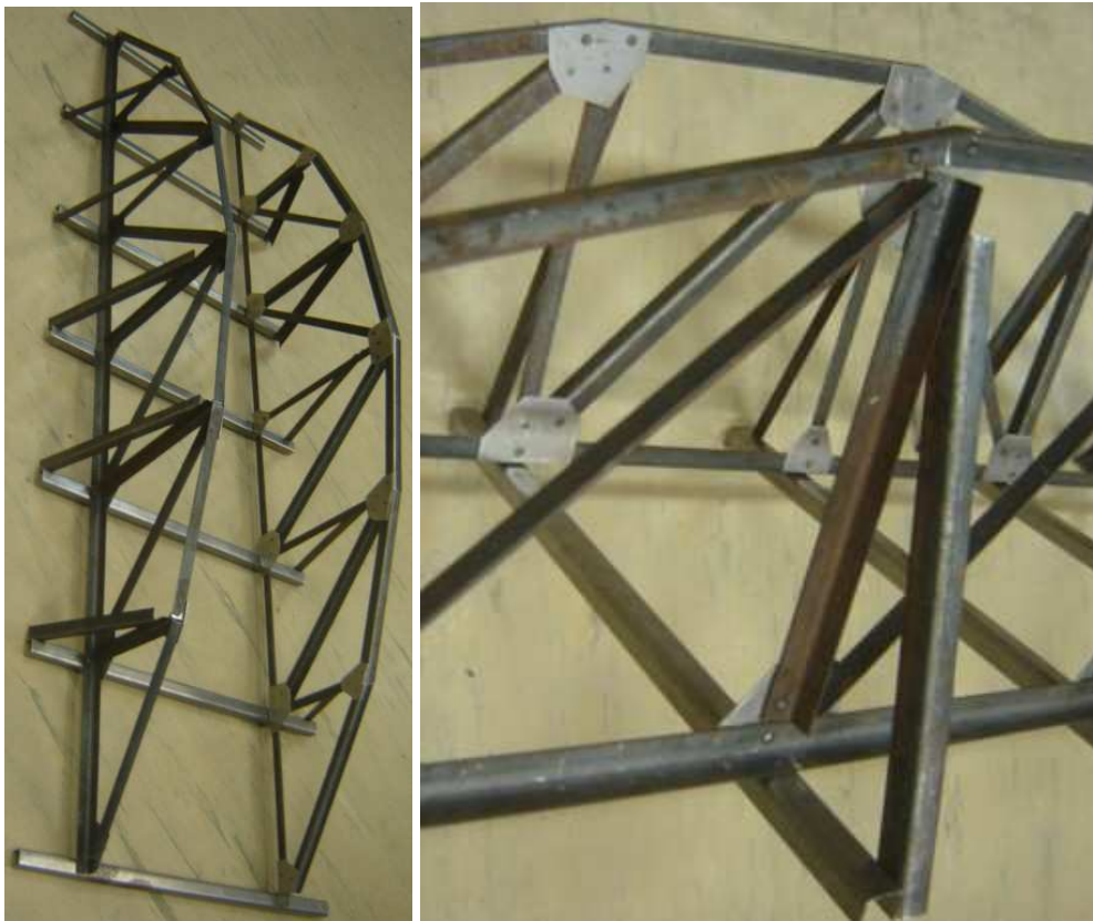
Obrázok 2 Zobrazenie modelu železničného mosta priehradovej konštrukcie
